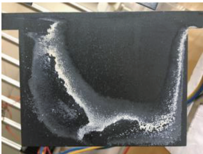
图6 电吸附抑垢装置内阳极板状电极结垢物
