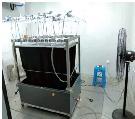
图3 小型化室内蒸发模拟实验装置
