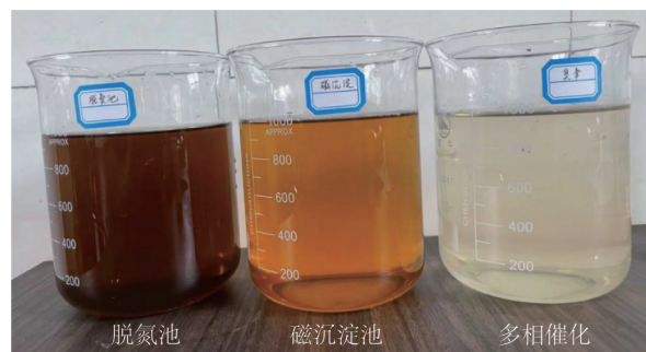
图6 深度处理系统各单元污水色度变化
