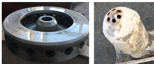
图5 雾化盘和喷枪运行3个月打开检查后照片
